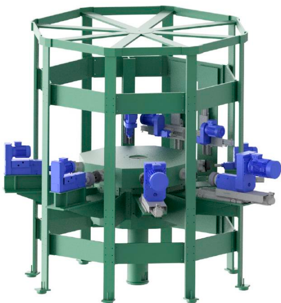
6. ábra A megtervezett 2. célgép 3D-s modellje
