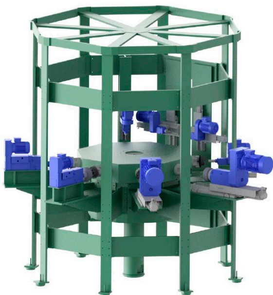
6. ábra A megtervezett 2. célgép 3D-s modellje
