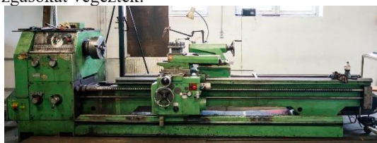
17. ábra. Egy klasszikus, robusztus egytemes eszterga (1960 - 1970-es évek) (méretpontosság kb. \pm 0,02-0,04 mm, felületi érdesség kb. R_a=0,8-25 \mu\text{m} ) [10]
