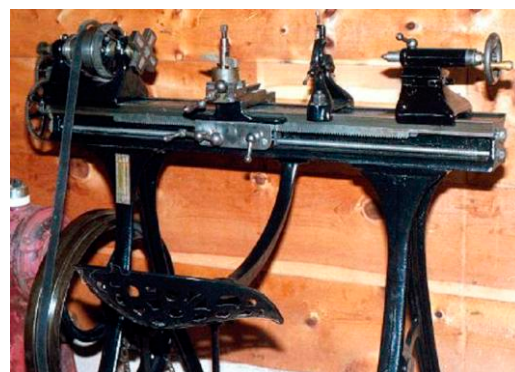
11. ábra. Öntöttvas gépágyas precíziós esztergagép (1860–1890 közötti időszak) (méretpontosság kb. \pm 0,02 – 0,05 mm, felületi érdesség kb. R_a=1,6 – 3,2 \mu\text{m} ) [6]
