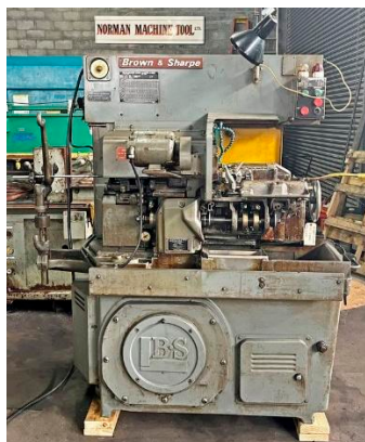
18. ábra. Egy klasszikus, ipari kivitelű Brown & Sharpe márkájú automata esztergagép (1960 - 1970-es évek) (méretpontosság kb. \pm 0,01-0,02 mm, felületi érdesség kb. R_a=0,4-12,5 \mu\text{m} ) [11]
