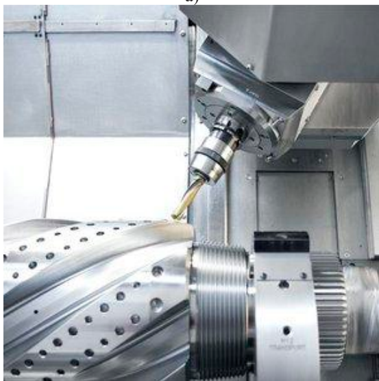
29. ábra. Modern CNC esztergaközpont automatikus gyártási környezetben (pozícionálási pontosság kb. \pm 0,004-0,006 mm, felületi érdesség kb. R_a=0.1-0.8 \mu\text{m} ) [20]
