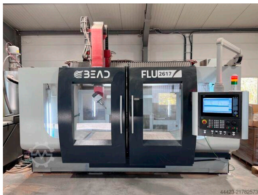
25. ábra. 5 tengelyes megmunkáló központ (Belotti FLU 2617) (2023) (pozicionálási pontosság kb. \pm 0,015 – 0,025 mm, felületi érdesség kb. R_a=0.8 – 1.6 \mu m ) [16]
