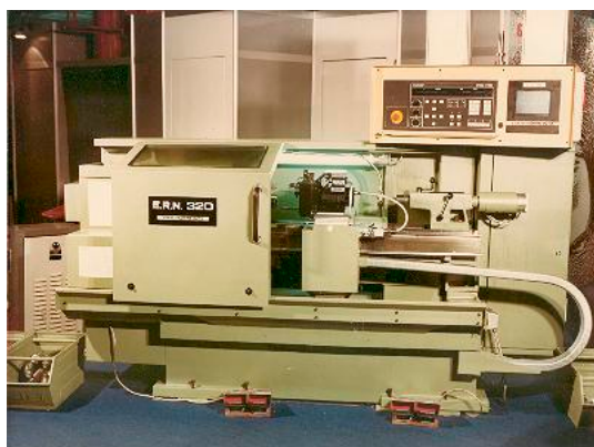
20. ábra. CNC eszterga az 1980-as évekből (méretpontosság kb. \pm 0,01-0,02 mm, felületi érdesség kb. R_a=0.8-12.5 \mu\text{m} ) [13]
