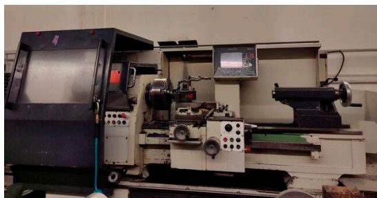
21. ábra. 1990-es évekbeli CNC-esztergagép zárt burkolattal és digitális vezérlőpanellel (méretpontosság kb. \pm 0,01-0,02 mm, felületi érdesség kb. R_a=0.8-12.5 \mu\text{m} ) [13]
