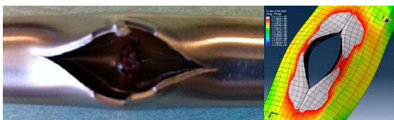
4. ábra. Cső repedési nyomásának meghatározása kísérleti és numerikus módszerek segítségével [13]
