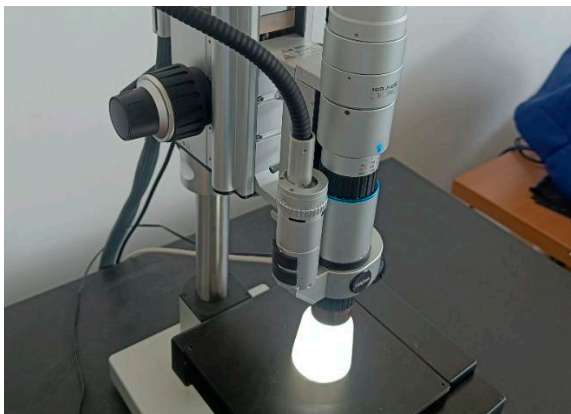
4. ábra A keresztmetszeti minta mikroszkópos vizsgálata (Hirox-MXB-2500RZE)
