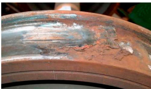
2. ábra. Vasúti kerék ellaposodása blokkolós fékezés hatására [2]
