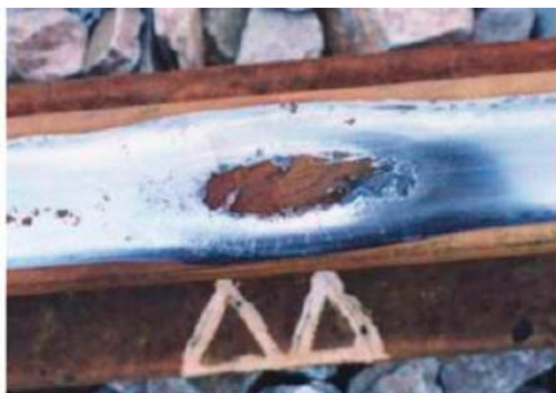
3. ábra. Kipörgő kerék okozta jelentős helyi kopás a vasúti sín futófelületén [3]
