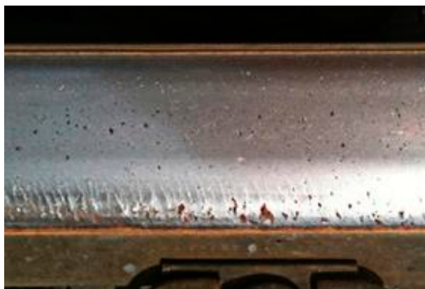
5. ábra. Head-check repedések a sín futófelületének peremén [5]
