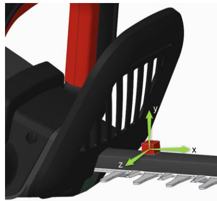
1. ábra: A sövényvágó pengéjénél található szenzor tengelyeinek értelmezése
