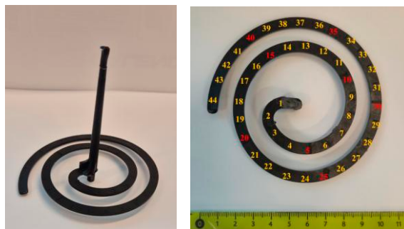
12. ábra: Spirál folyási PP próbatestek
