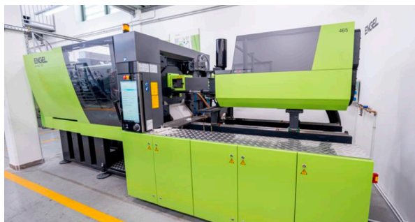
1. ábra: Az Engel E-Mac 465/180 Fast Track elektromos fröccsöntő gép
